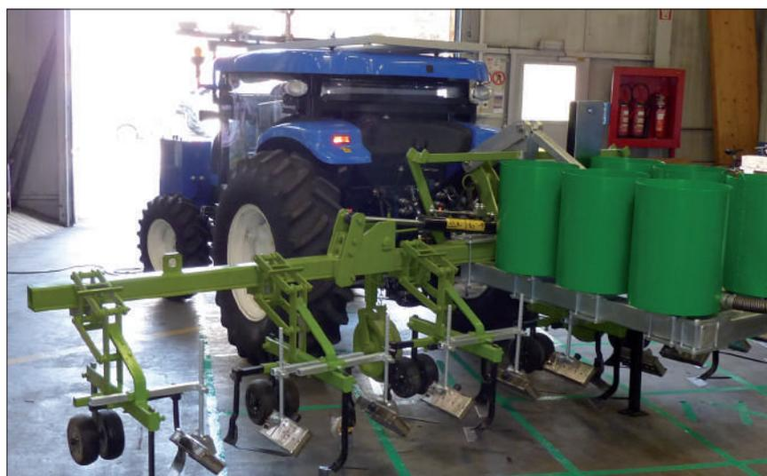
Figura 7. Prototipo de escardadora de precisión desarrollado por investigadores de la Universidad de Pisa, con herramientas de control térmico y mecánico.
