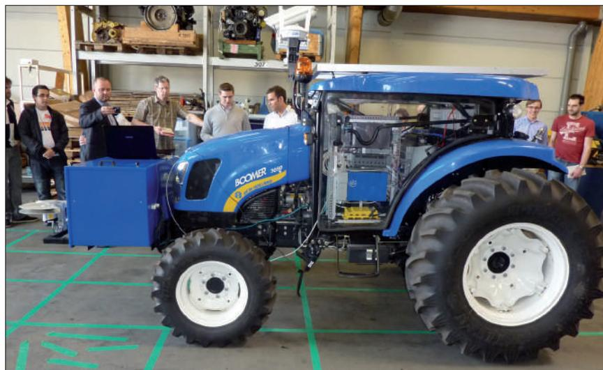
Figura 6. Vehículo autónomo terrestre construido sobre la base del tractor Boomer T3050 CVT de New Holland.
