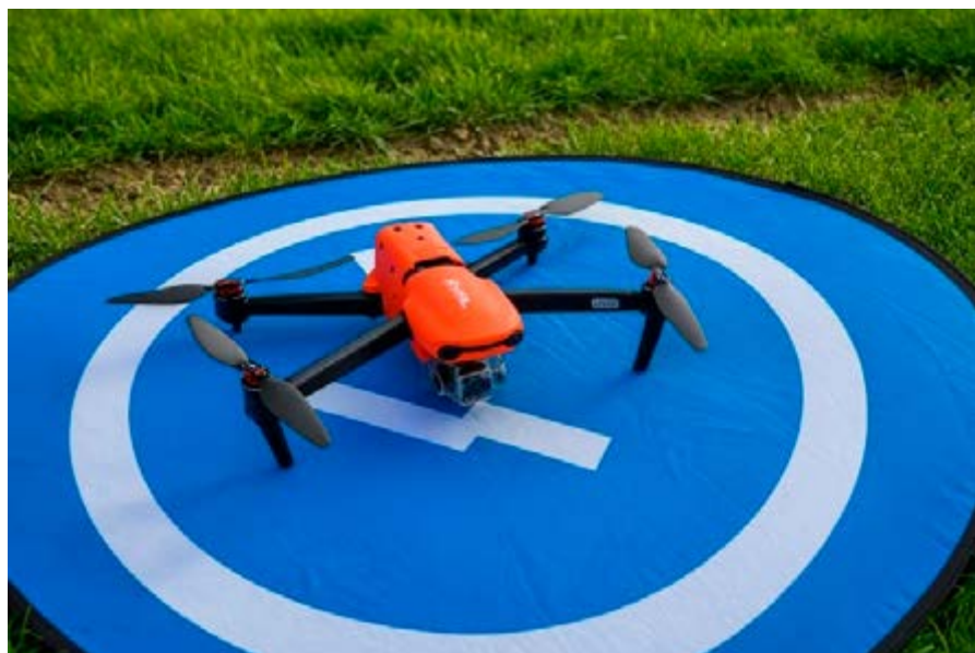
Foto 2. Cuadricóptero Autel EVO 2 ProV3 equipado con cámara RGB usado en los vuelos.
