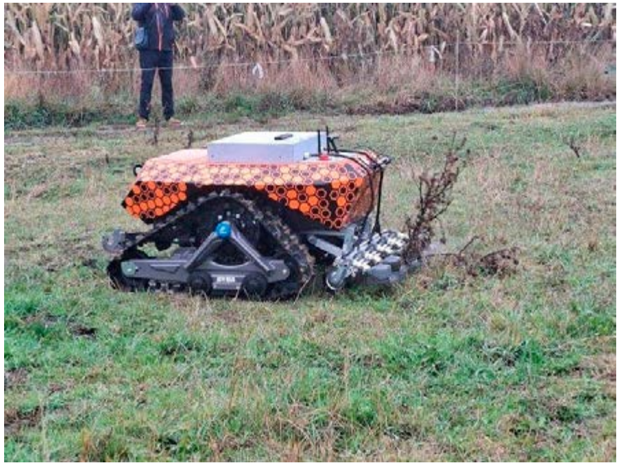
Foto 3. Dron terrestre diseñado para la siega automática de las zonas no pastadas.
